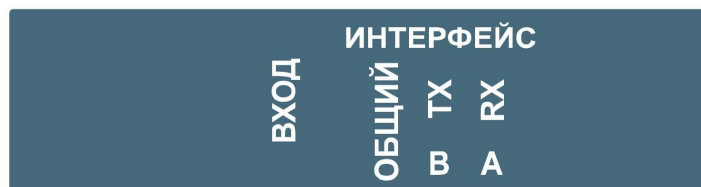
Рисунок 2а. Расположение клемм на нижней части крышки
